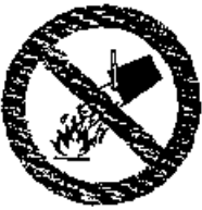
Verboden met water te blussen
